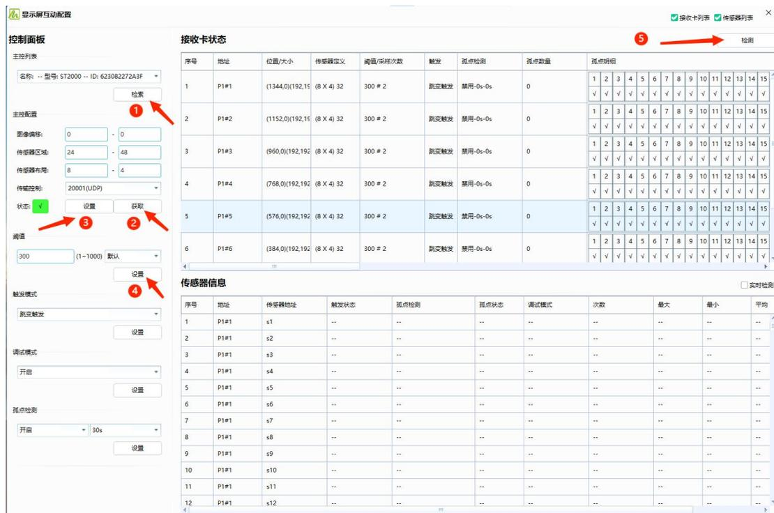
8、关闭 AutoLED, 打开 FloorLED 软件调整传感器布局，按“Ctrl+shift+S”打开传感器布局界面，如下图所示：
